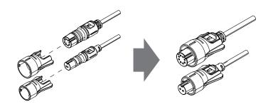
図の向きでカラーをしっかりと差し込 みます。かなり力を入れないと奥まで 差し込まれません。 カラーが差し込みされれば、引っ張っても抜けません。カラーは完全に固定されず、カタカタと少し動きます。
