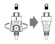
南京錠のマークを上にして本体へ差し 込み、カラーを時計回りに 90 度回転 させると、ケーブルが本体へロックさ れます。
